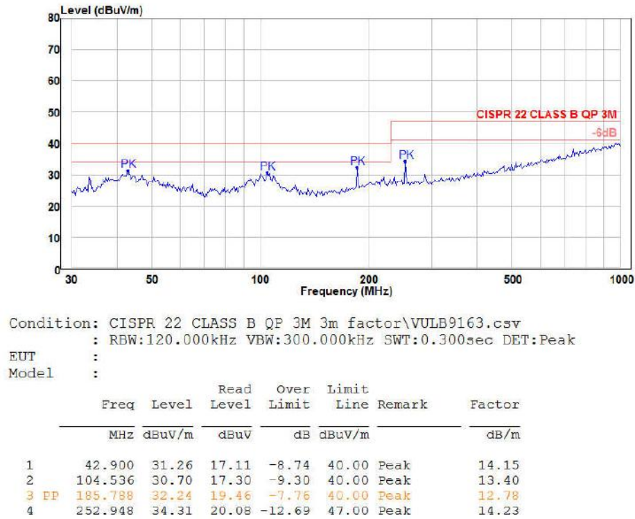
图 5-6 RE 测试垂直方向
